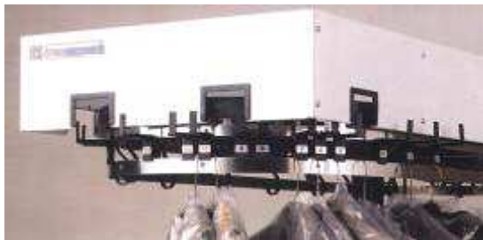
Version Continuo avec Bandage de garniture carré hauteur 200 mm.
