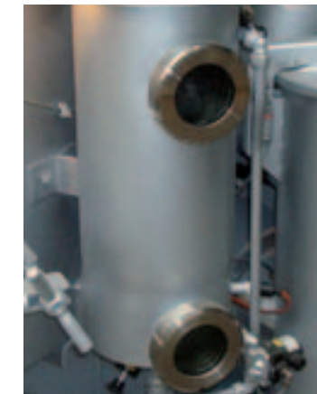
Sans maintenance - le séparateur d'eau autonettoyant avec 2 ème séparateur d'eau de sécurité
