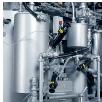
Le système du séparateur d'eau empêche la formation d'odeurs.
